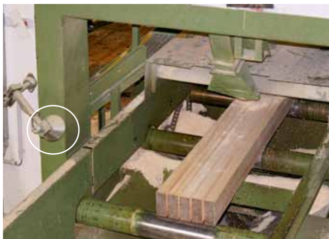
Ein kleines Mikrofon hört die Schallemissionen der Kreissägen, erkennt zuverlässig Zwickler und verhindert Sägeblattschäden und Stillstände
