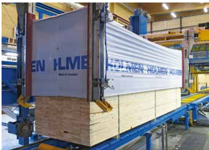
CGVs Hüllenroboter greift die Folie an den vier Eckseiten, dehnt sie um wenige Zentimeter und schiebt sie über den Stapel
